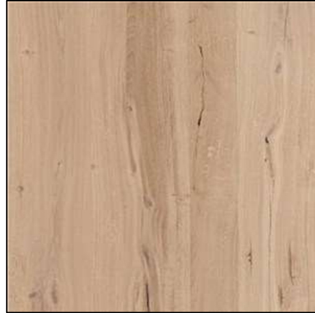
Eiche furnierte Holzträgerplatte –astig + rissig
